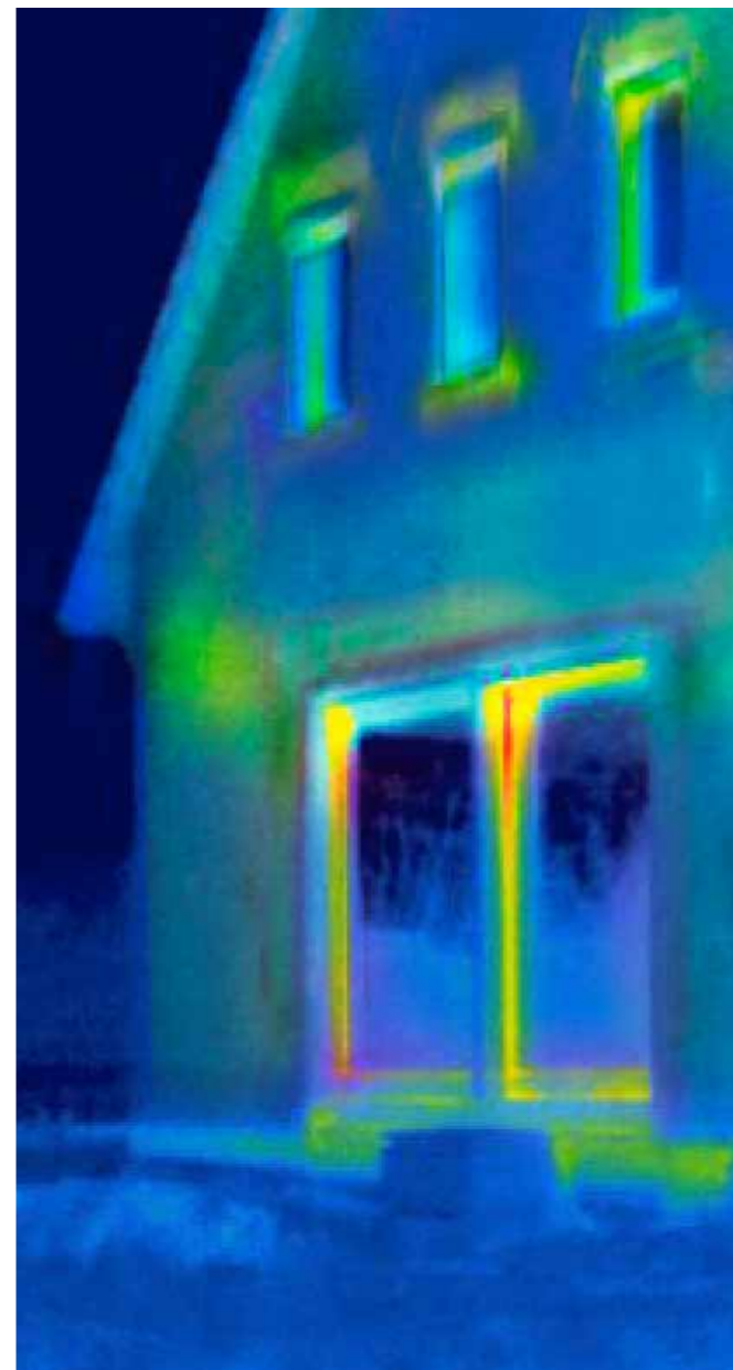
Prieš renovaciją: dideli šilumos nuostoliai paveikslėlyje pavaizduoti raudonai.
