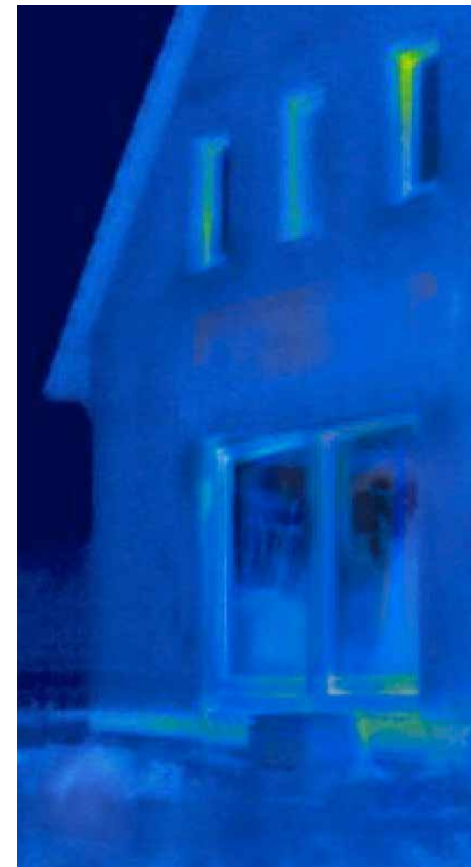
Po renovacijos: dėl stumdomųjų durų „GENEIO“ prarandama ženkliai mažiau šilumos.
